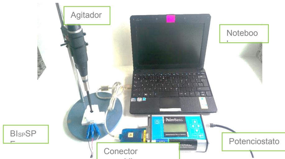
**Figura 1.** Equipo experimental para las medidas voltamperométricas.
